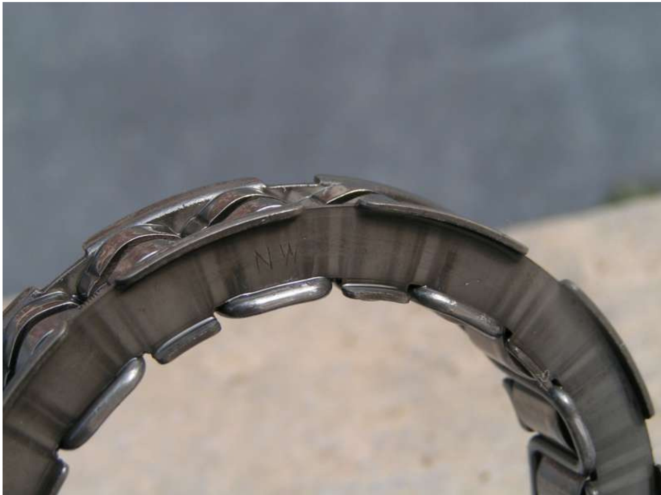
Le ressort et les galets (20 au total). Repère du sens de montage par une fine encoche
